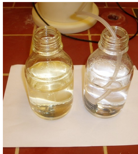
Abbildung 5-23: Optischer Vergleich, Vor- und nach der Ozonierung (Bleicheffekte)
