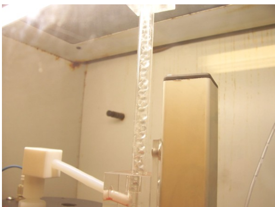
Abbildung 5-19: Reaktions-Säule mit Glasperlen, 6 mm
