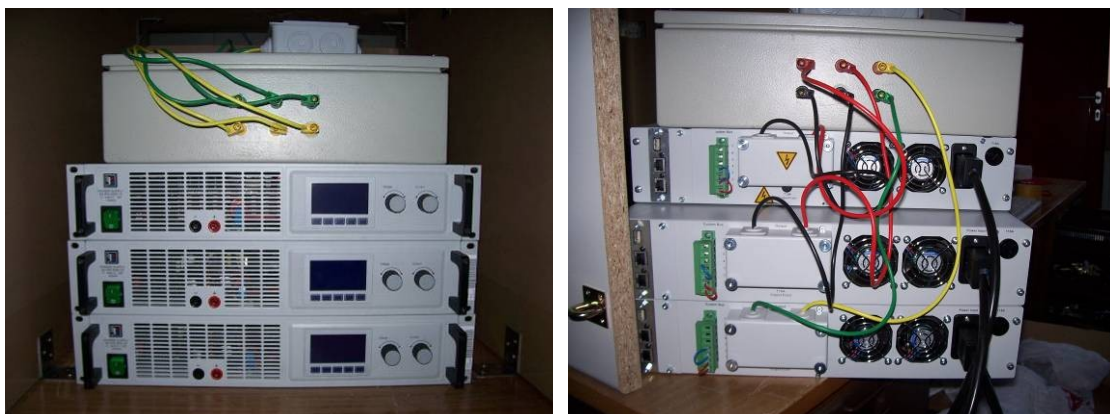
Abbildung 5-25: links: Netzgeräte von vorne; rechts: Anschlüsse der Netzgeräte hinten; oben: Umpoleinrichtung
