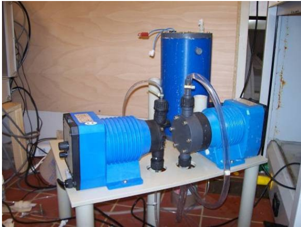
Abbildung 5-15: Weiterentwickelter Ozongenerator, links: Abwasserpumpe, rechts: Elektrolytpumpe
