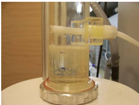
Abbildung 5-10: Eindüsung des erzeugten Ozons
