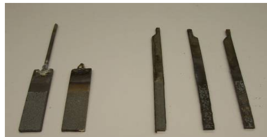
Abbildung 5-13: Diamantelektroden auf Ti-Oxid-Träger (links einseitig, rechts doppelseitig beschichtet)
