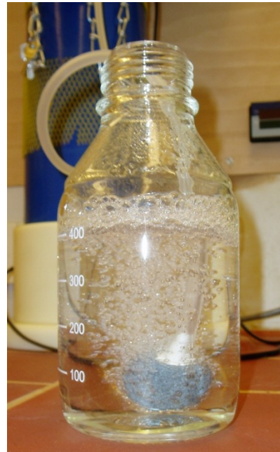
Abbildung 5-22: Einsatz einer porösen Kugel für die Kontaktierung mittels Blasensäule
