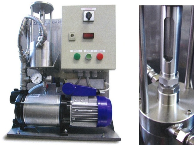
Abbildung 6-3: links BALS-Steuereinheit mit Pumpe und Reaktionskammer, rechts: Reaktionskammer mit beidseitig tangentialem Wassereinlauf unten und Wasseraustritt an der Oberseite (BALS 2009)
