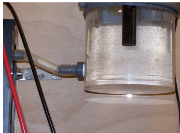
Abbildung 5-7: Ausschnitt der Meßarmatur, Blasenbildung aufgrund der Oxidationsmittel
