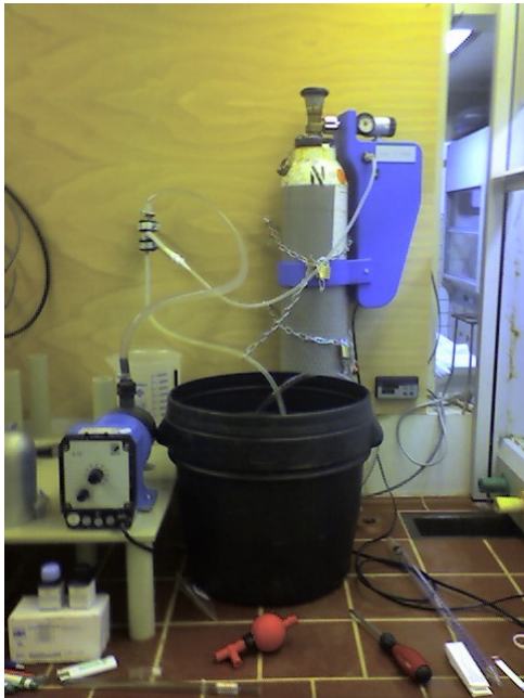
Abbildung 5-20: Ozonerzeugung mittels Corona-Entladung, Venturi-Injektor
