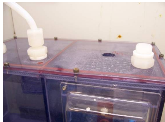
Abbildung 5-14: Prototyp d. Ozongenerator, links: O 3 -Öffnung, rechts: H 2 -Öffnung
