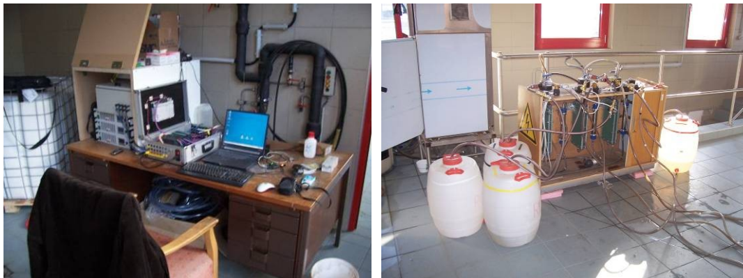
Abbildung 5-24: links: Trockenraum mit Steuerung; rechts: Naßraum mit den Reaktoren
