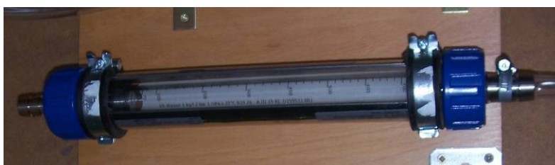
Abbildung 5-28: Durchflußmesser mit Schwebekörper (liegend fotografiert)
