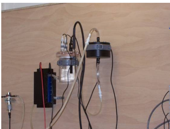
Abbildung 5-4: Reaktor mit Meßarmatur inkl. Sensoren und Katalysator
